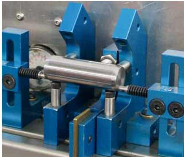
Bild 1. Untersuchung eines 60 mm langen Lagerbolzens auf Länge und Planparallelität mit einer Messvorrichtung. Die Anzeigeeinheit zeigt Messwerte in einem engen Toleranzbereich um 60 mm in großen Zahlen mit drei Stellen hinter dem Komma in Grün (IO) an und alarmiert mit rot eingefärbten Zahlen bei Fehlteilen (NIO).
