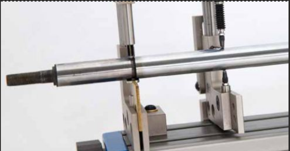
Lineareinheit zum Prüfen von Geradheit und Zylindrizität
