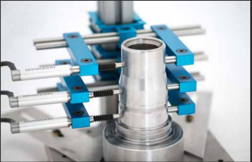
Horizontaler Pendelhalter zum Prüfen von mehreren und größeren Durchmessern
