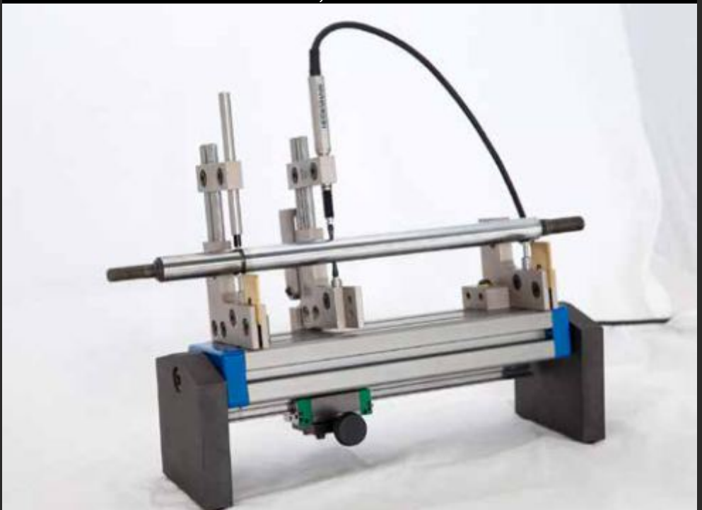
Lineareinheit zum Prüfen von Geradheit und Zylindrizität
