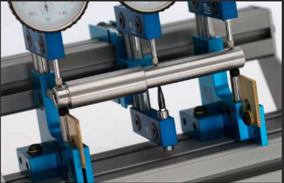
Vertikaler Pendelhalter zum Prüfen von mehreren Durchmessern
