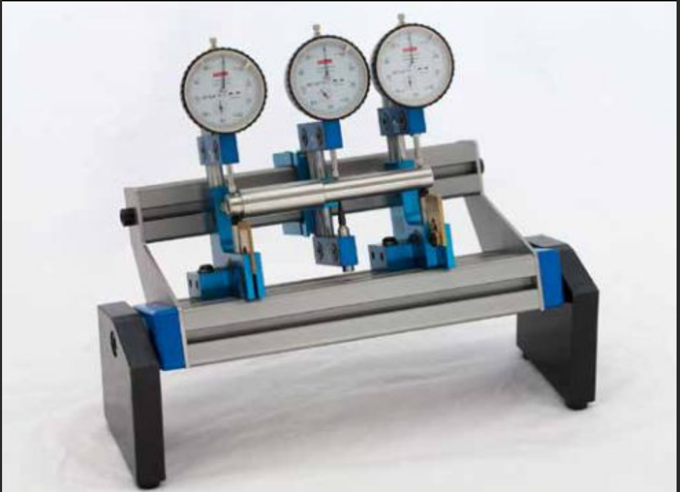
Vertikaler Pendelhalter zum Prüfen von mehreren Durchmessern
