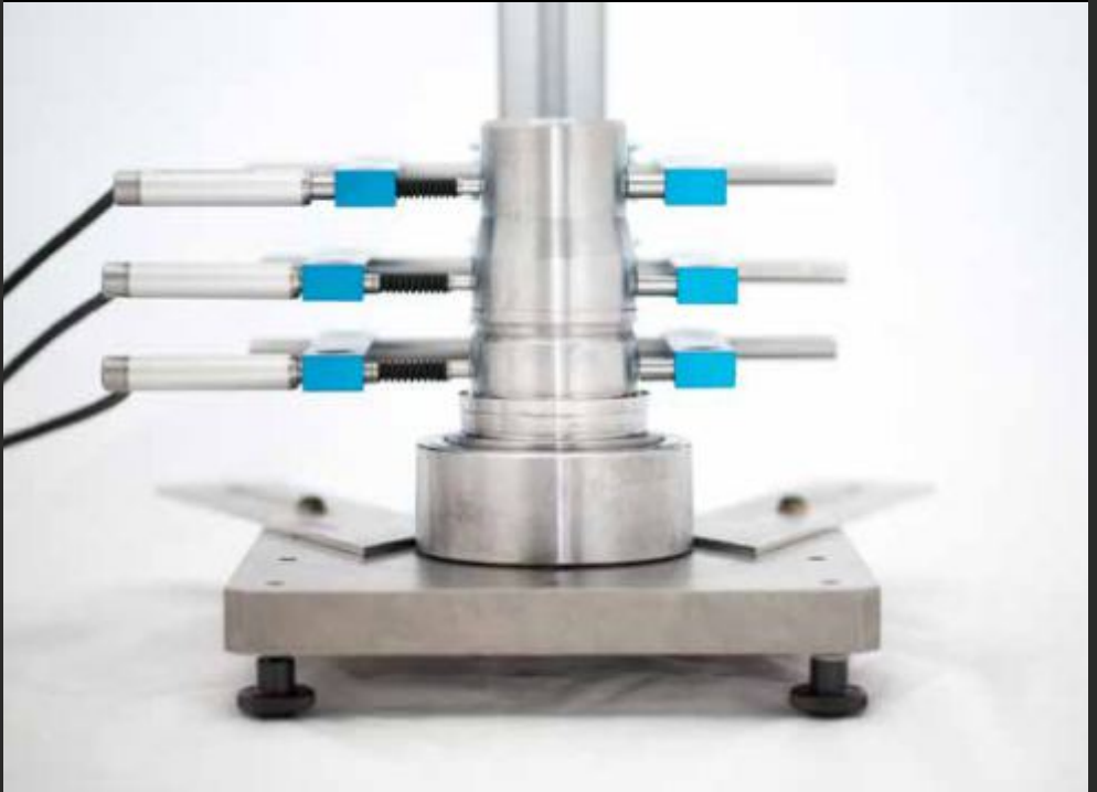
Horizontaler Pendelhalter zum Prüfen von mehreren und größeren Durchmessern
