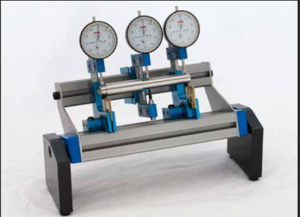
Vertikaler Pendelhalter zum Prüfen von mehreren Durchmessern
