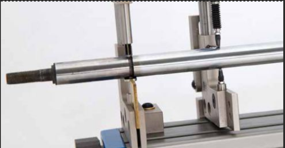
Lineareinheit zum Prüfen von Geradheit und Zylindrizität
